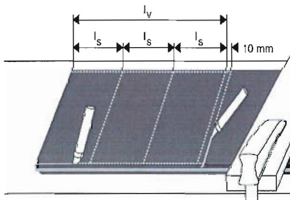
След това се нарязва покривния слой на ленти (около 20-30 мм широки) и се отстраняват с клещи ръчно или механизирано със захващащи приспособления. Отрязват се кантовете с ъглов нож.
