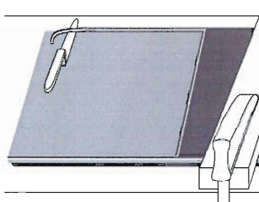
С нож за рязане на текстилни слоеве се изрязва най-горния текстилен слой на 10 мм от гуменото покритие. След това се отстранява с помощта на инструмент за повдигане на слоеве и клещи (или механизирано). Отбелязват се следващите текстилни слоеве спрямо дължината на стъпалата (Is), отрязват се по същия начин с нож и се отделят. Последният текстилен слой трябва да бъде запазен. Отрязват се кантовете спрямо текстилните слоеве с ъглов нож.
