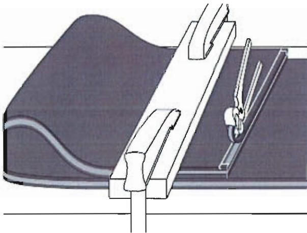
Долната част на лентата се огъва обратно (връща се в хоризонтална положение), като този път от другия ѝ край се отбелязват дължината на снадката  $l_v$ , дължина на стъпалата  $l_s$  и кантовете. На 10 мм от линията на снадката се начертава паралелно още една линия. Отрязва се покривния слой косо под ъгъл 45 градуса с нож Дон Карлос. Отрязват се кантовете с нож, държан вертикално, без да се наранява текстилният слой. През цялото време на работа се внимава да не се наранят текстилните слоеве!
